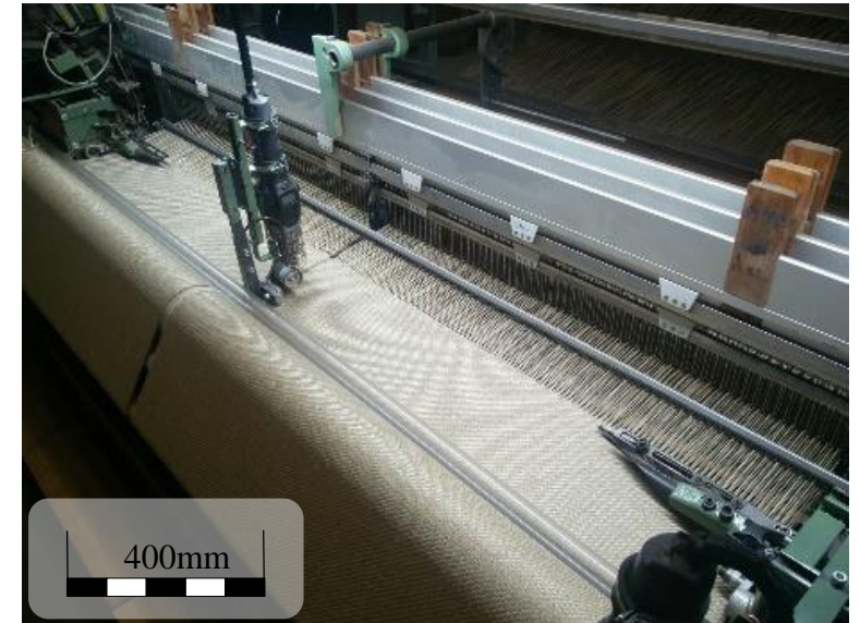
Übersicht über den Webprozess von Gustav Gerster GmbH mit Flachs-Garn
